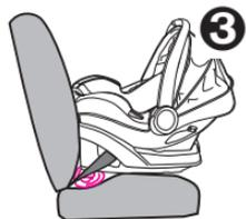
**Lors de l'utilisation du siège de retenue pour bébé sans la base, S'ASSURER** qu'il est bien au niveau par rapport au sol. L'indicateur de niveau rouge qui se trouve sur l'étiquette de mise en garde (voir l'illustration ❹ à la page 27) **DOIT** être de niveau avec le sol.
