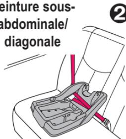
3. Boucler la ceinture de sécurité du véhicule. S'assurer que la languette de boucle soit insérée dans la bonne boucle ③. **La ceinture de sécurité du véhicule ne doit pas être tordue ni tournée.**
