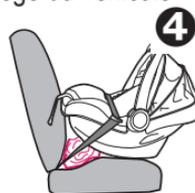
Réajuster au besoin la ceinture de sécurité du véhicule afin d'ancrer solidement le siège de retenue pour bébé au siège du véhicule.
